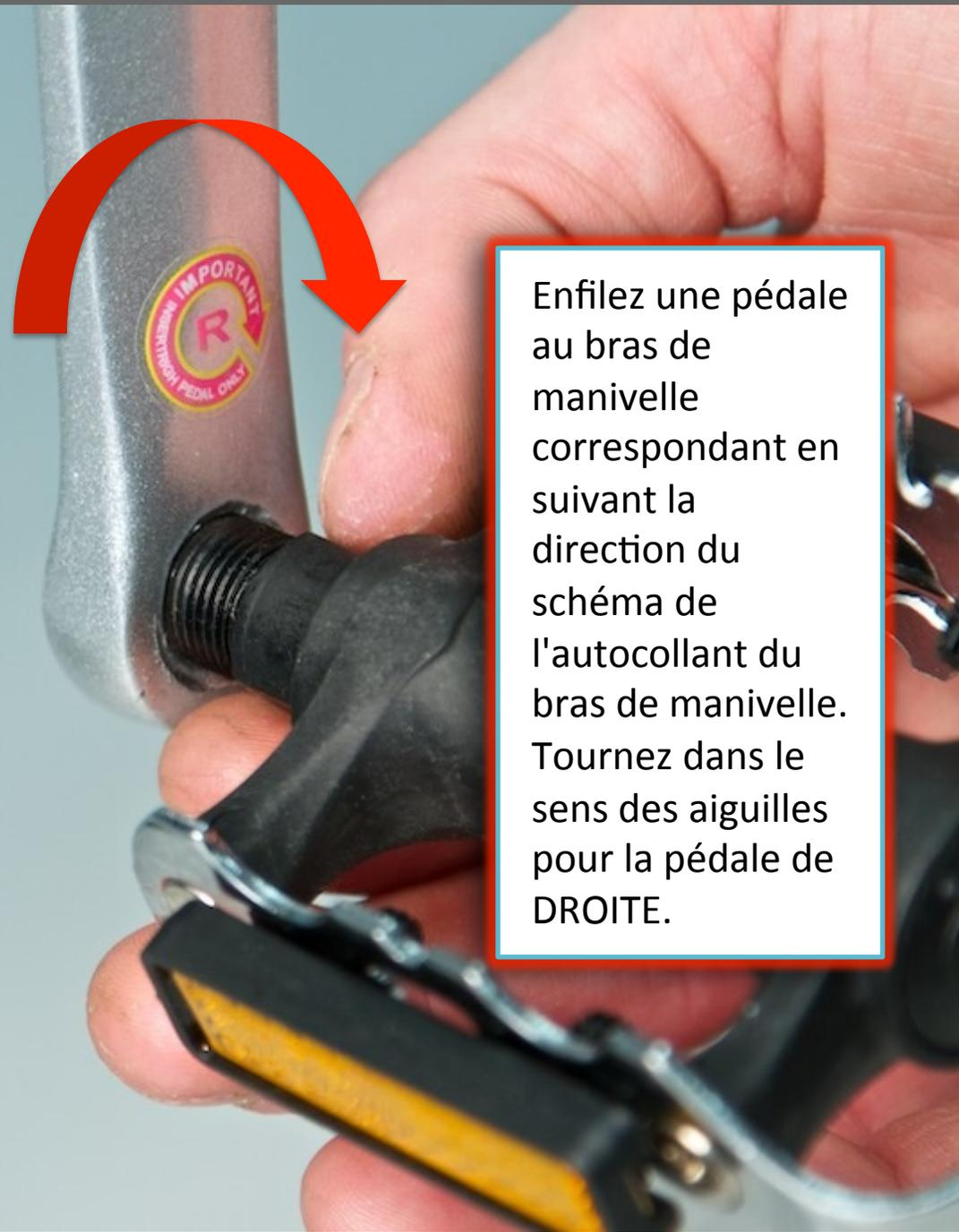
Enfilez une pédale au bras de manivelle correspondant en suivant la direction du schéma de l'autocollant du bras de manivelle. Tournez dans le sens des aiguilles pour la pédale de DROITE.
