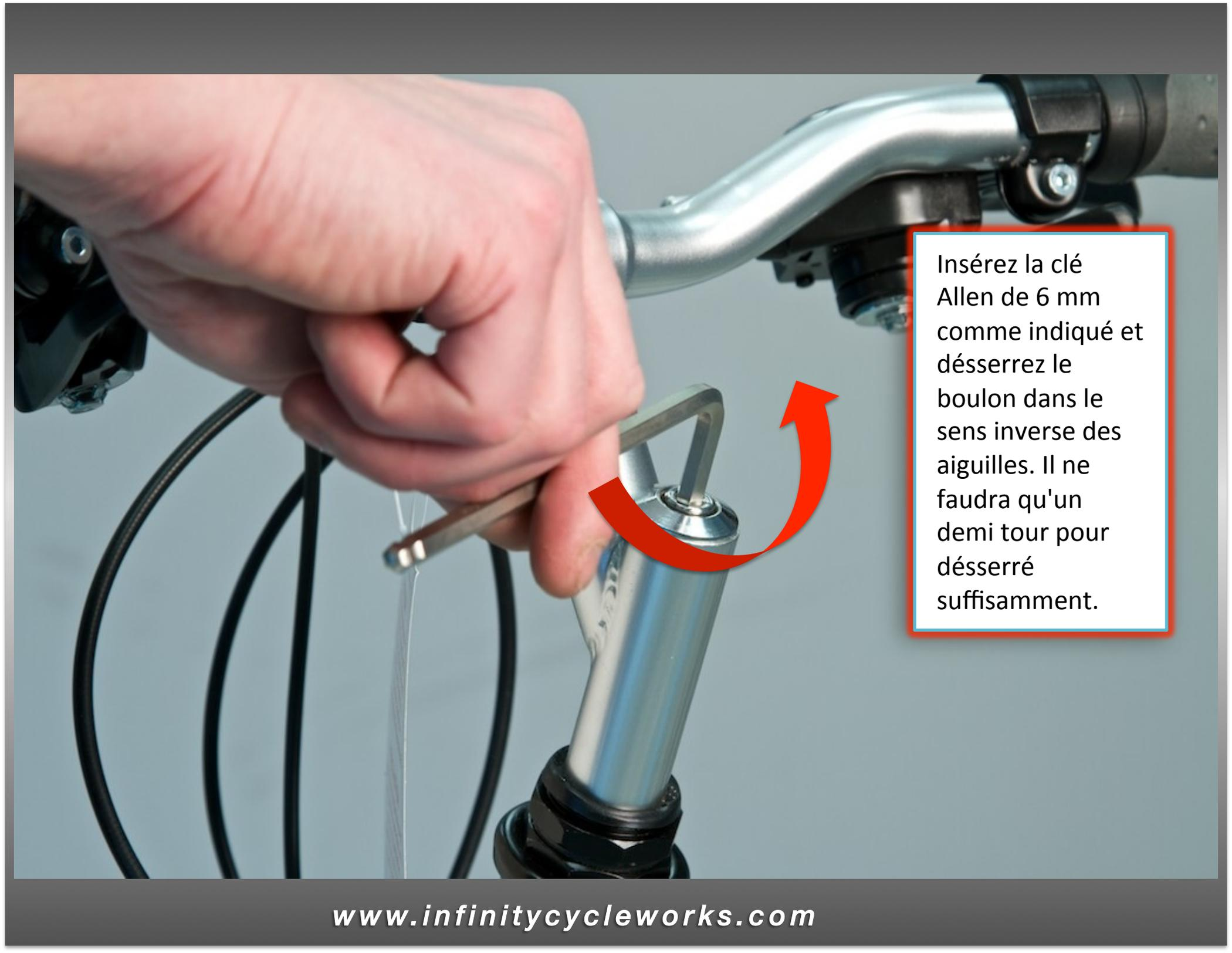
Insérez la clé Allen de 6 mm comme indiqué et désserrez le boulon dans le sens inverse des aiguilles. Il ne faudra qu'un demi tour pour désserré suffisamment.
