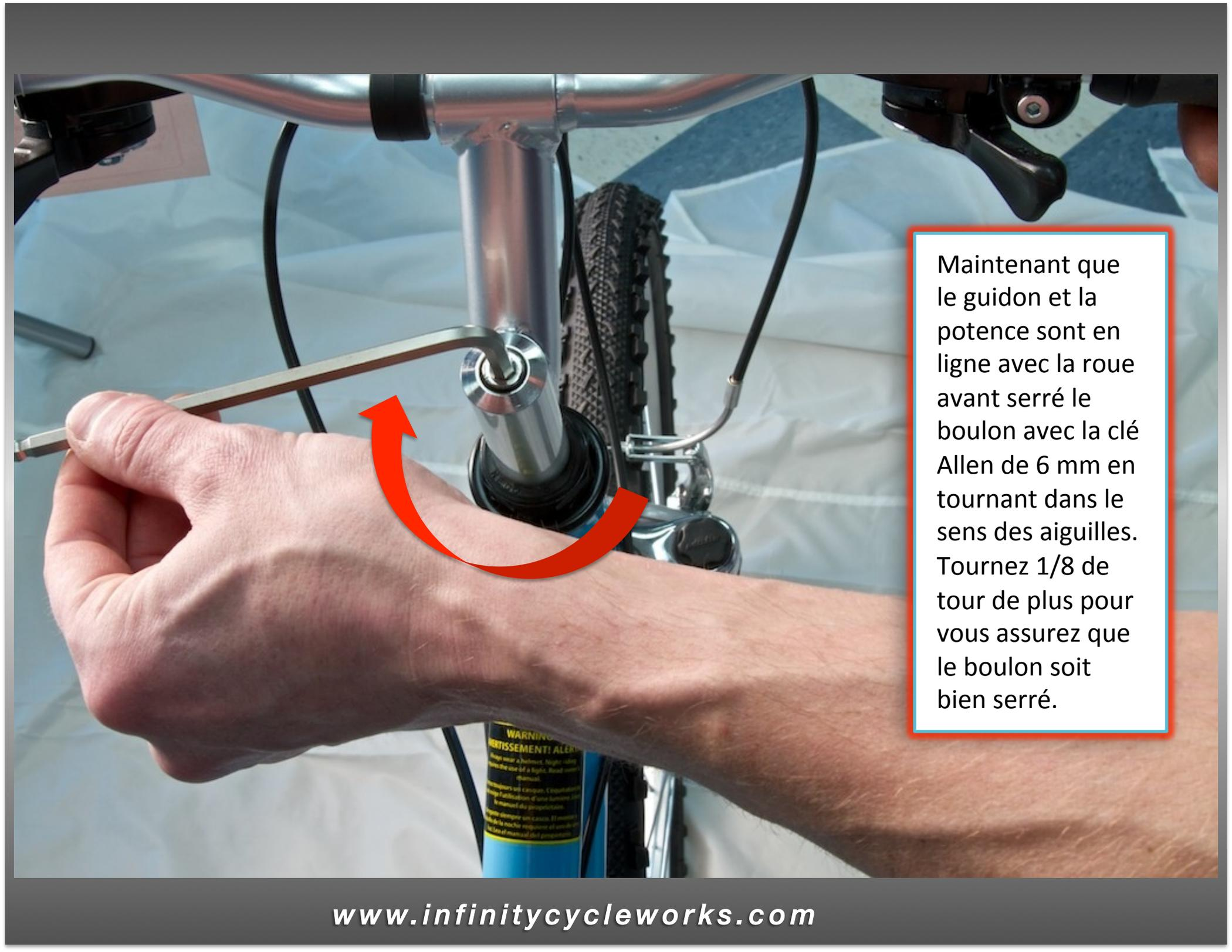
Maintenant que le guidon et la potence sont en ligne avec la roue avant serré le boulon avec la clé Allen de 6 mm en tournant dans le sens des aiguilles. Tournez 1/8 de tour de plus pour vous assurez que le boulon soit bien serré.
