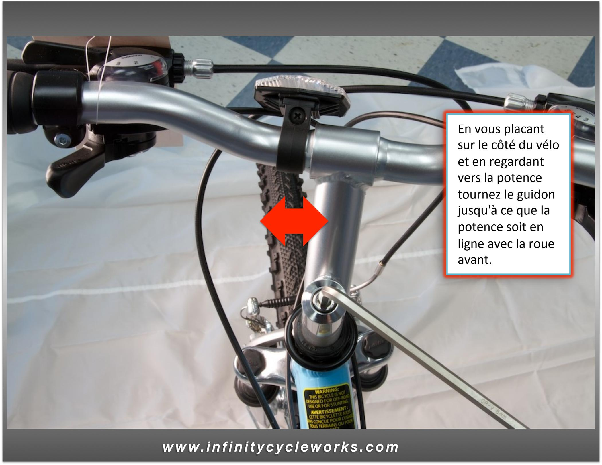
En vous plaçant sur le côté du vélo et en regardant vers la potence tournez le guidon jusqu'à ce que la potence soit en ligne avec la roue avant.
