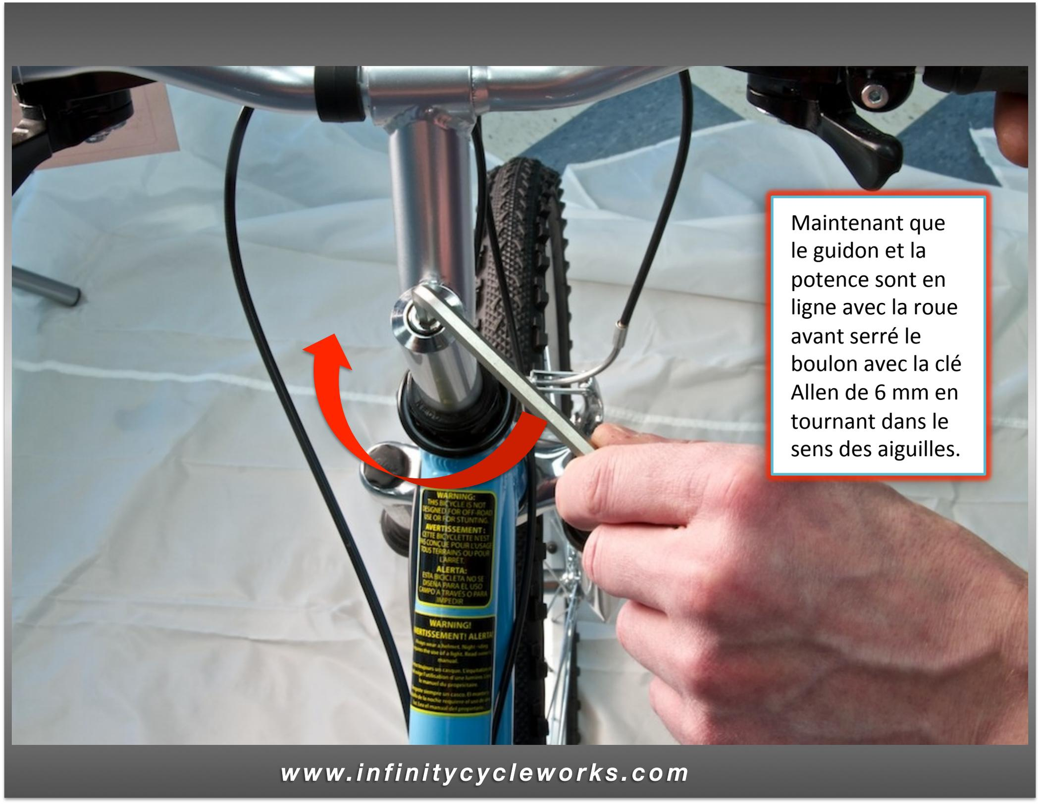
Maintenant que le guidon et la potence sont en ligne avec la roue avant serré le boulon avec la clé Allen de 6 mm en tournant dans le sens des aiguilles.
