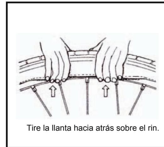
8. Vuelva a montar un lado de la llanta en el rin.
